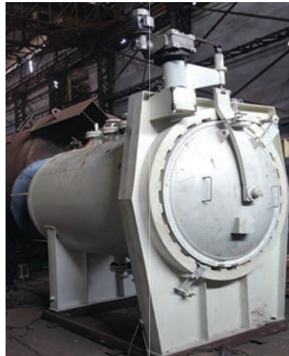
चित्र 21 आईआईटी दिल्ली के लिए उच्च ताप एवं उच्च दाब लैब स्केल ऑटोक्लेव। यूसीई, मुंबई में संविचरणाधीन आटोक्लेव।
