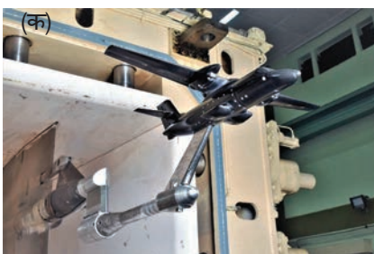
चित्र 8 (क) सारस एमके-2 ट्रैक्टर संस्करण पवन सुरंग मॉडल एवं (ख) सारस एमके-2 ट्रैक्टर वायुयान का पावर ऑन स्थिति में सतह दाब वितरण एवं वेक स्ट्रीमलाइन।
