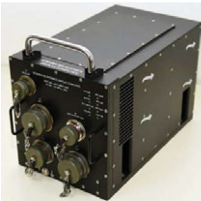
चित्र-1 इंटीग्रेटेड एवियोनिक्स प्लाइट कंट्रोल कंप्यूटर बीएमएस एप्लिकेशन के साथ होस्ट किया गया।
