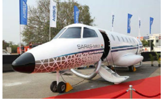
चित्र - 4 इंटीरियर कॉकपिट, केबिन और ईसीएस प्रणाली के साथ सारस एमके II फ्यूजलेज का भौतिक मॉक-अप।
