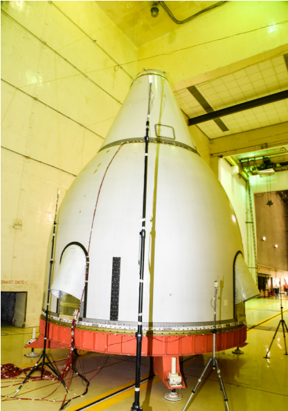
सीएसआईआर-एनएएल में ध्वनिक परीक्षण के तहत गगनयान परीक्षण यान कू एस्केप प्रणाली
